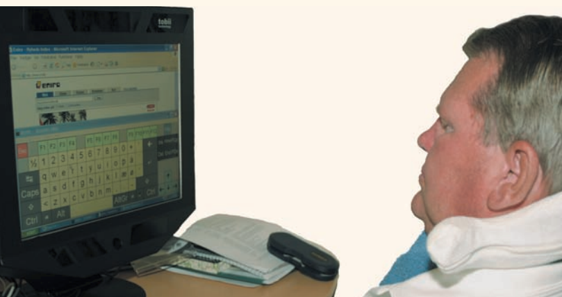
Jens Hansen framför datorn. Han använder ett ögonstyrningssystem och ett skärmtangentbord för att skriva.
